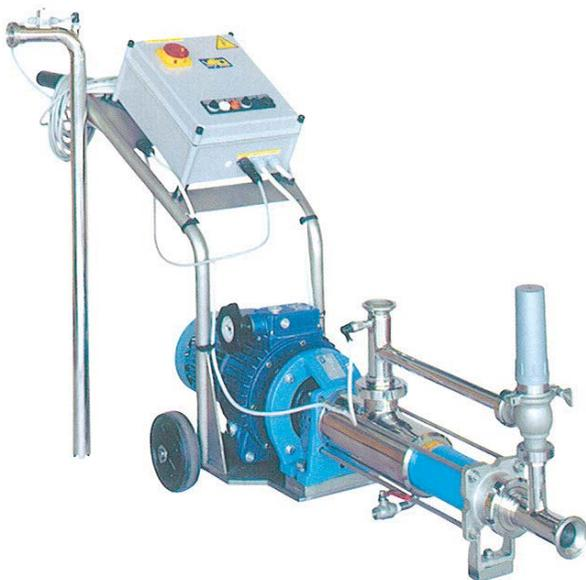
Les pompes peuvent être alimentées avec un moteur réducteur de débit fixe ou avec un moteur de tour à vitesse variable, au débit variable. Ce sont des pompes de fabrication robuste, et le stator de caoutchouc vulcanisé est directement sur le tube d'acier.
