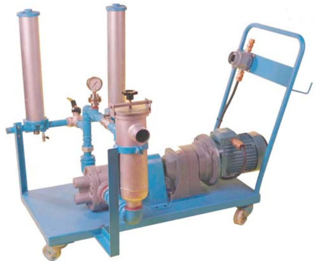
Pompe d'engrenages avec pré-filtre 2" et deux filtres cuno longs (20")
