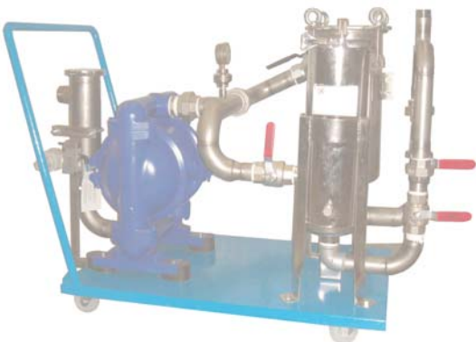
Ligne de transvasement avec pompe à membrane qui envoie vers une poche filtrante ou bien à une carcasse en acier inoxydable avec 3 filtres cuno de 10"
