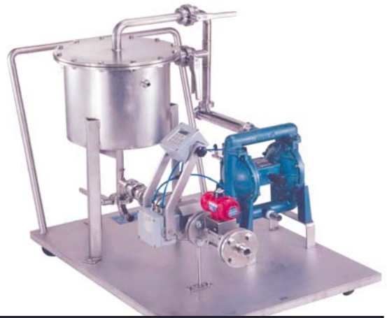
Ligne de dosage avec pompe pneumatique, purge de l'air, compteur à roue ovale et un programmeur
